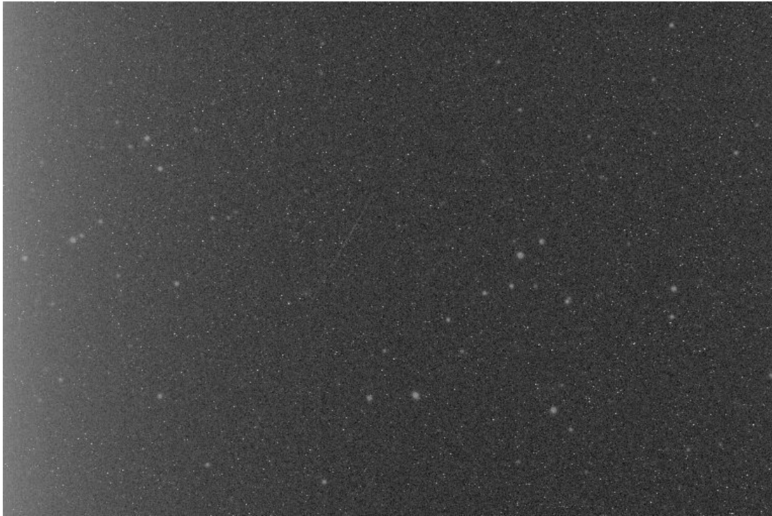
Abb. 14: Beispiel für ein Masterdark. Man sieht links das Leuchten der Ausleseelektronik im Infraroten sowie zahlreiche sog. "Hot Pixel".
